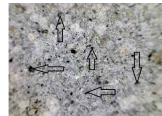
Tynk renowacyjny THERMOPAL SR 24 z widocznymi komorami powietrznymi (powiększenie x 200).
